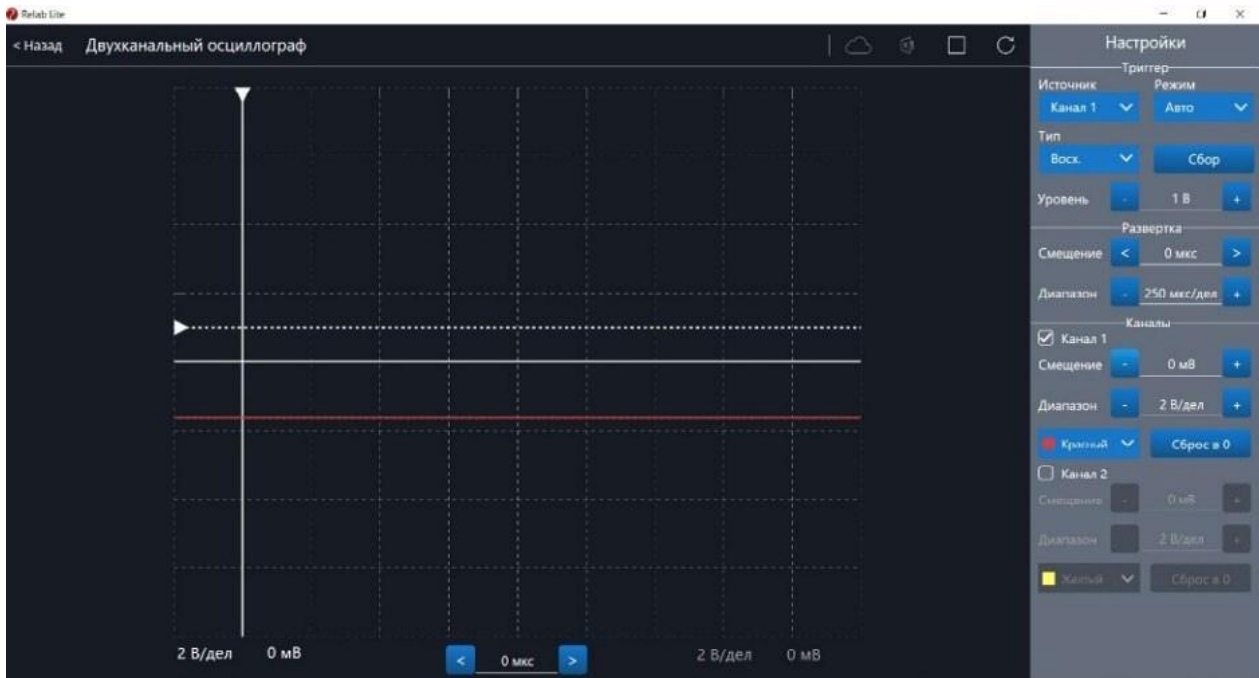
Рис. 40. Сигнал с ненулевым смещением
